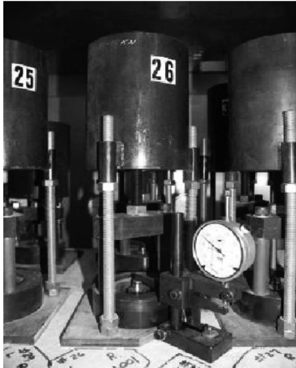
圖25 拉伸潛變試驗設備圖例
