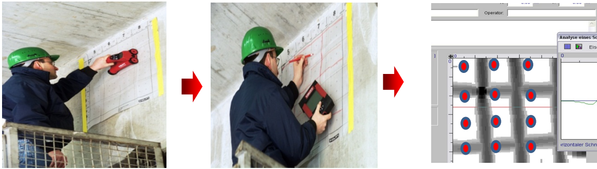
圖29 鋼筋探測流程範例
