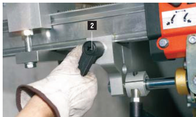
2 Dispositivo di fissaggio dello stelo dello stantuffo In seguito liberare il fermo di rilascio e il dispositivo di fissaggio dello stelo dello stantuffo. Inserire completamente lo stelo dello stantuffo, facendolo scorrere e poi bloccarlo in posizione.
