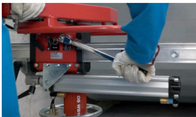
Excenterbouten inschuiven en met de klok mee vastdraaien. Eindstop monteren.
