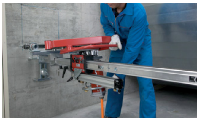
Spanhaak in opnamesleuf inbrengen.
